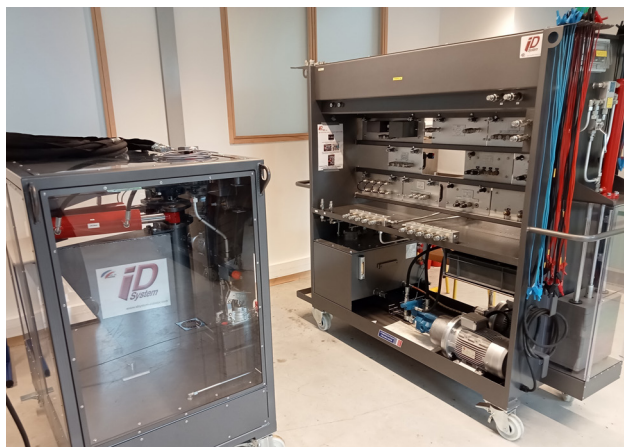
Installation simulant un appareil à gouverner
